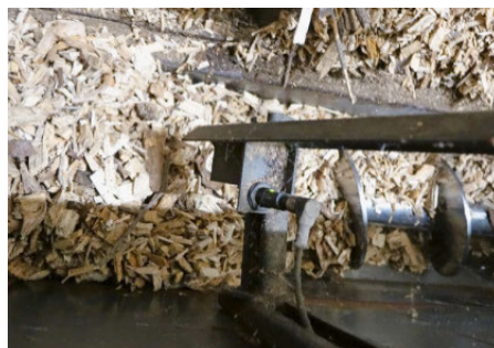
Die Sensoren der Transportschnecken richtig auszurichten und sie gegen täuschende Holzstücke zu schützen, ist eine Wissenschaft für sich ...
